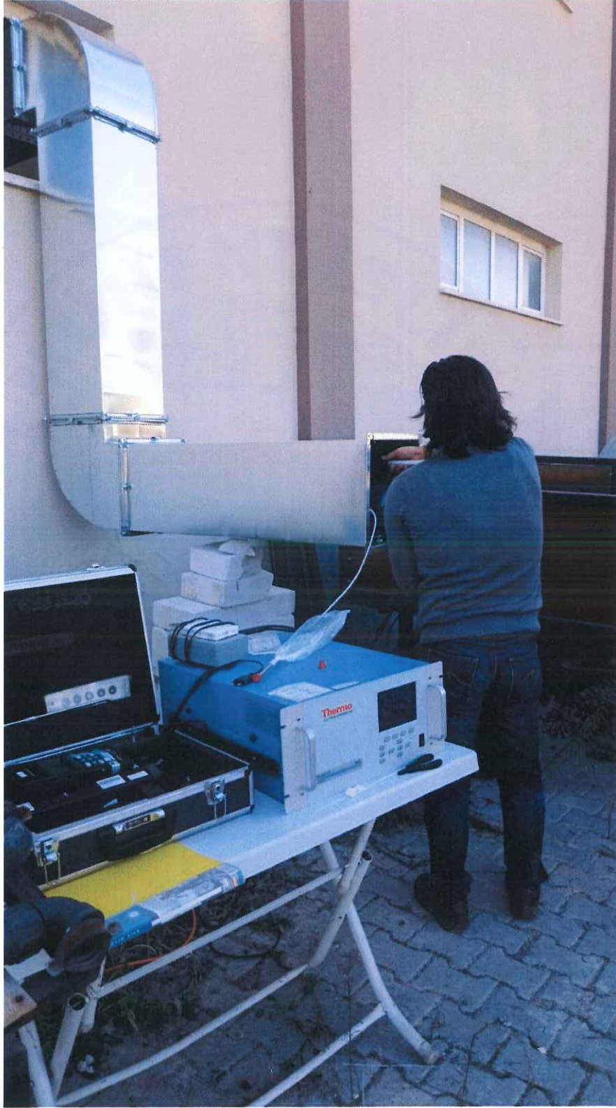
Resim 4. Koku kontrol sistemi çıkışında örnek alınması ve Ozon ölçümleri
